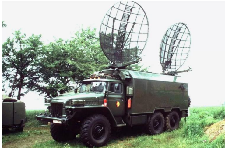
Рис. 2.1. Тропосферная станция (ТРС) «Р-423»
